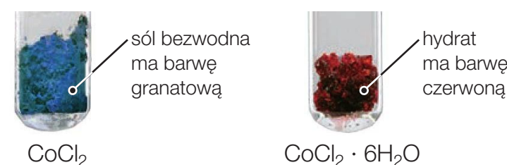
Fot. 56. Barwy chlorku kobaltu(II) w zależności od stopnia uwodnienia.
