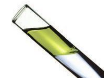
Fot. 82. Olej z wodą tworzą mieszaninę niejednorodną.
