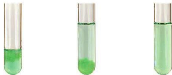
próbka kontrolna – probówka zawierająca świeżo strącony wodorotlenek niklu(II)
