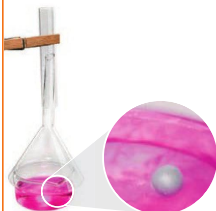
Fot. 38. Otrzymywanie wodorotlenku sodu w reakcji sodu z wodą.
