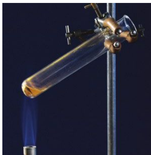
Fot. 22. Reakcja rozkładu tlenku rtęci(II).
