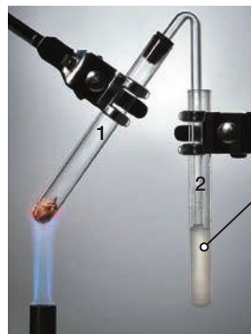
Fot. 59. Termiczny rozkład wapieni.
