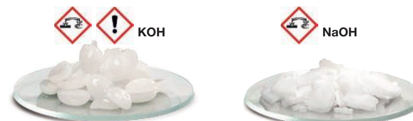
Fot. 41. Wodorotlenki potasu i sodu są substancjami o stałym stanie skupienia, które dobrze rozpuszczają się w wodzie i są higroskopijne.
