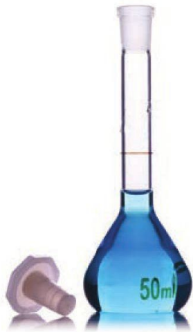
Fot. 93. Kreska na szyjce kolby miarowej wskazuje poziom cieczy odpowiadający pojemności kolby.
