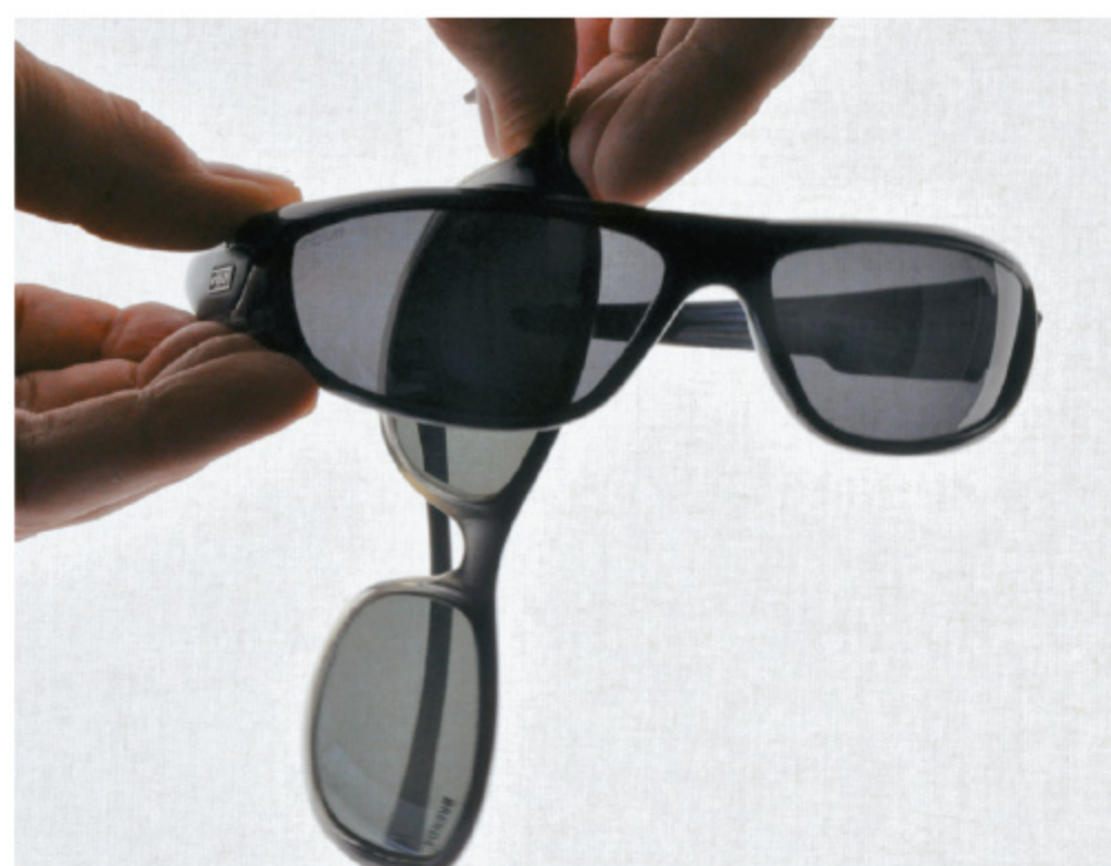
Ryc. 12.6. Niektóre okulary przeciwsłoneczne mają szkła wykonane z polaryzatora, który przepuszcza tylko światło o określonej polaryzacji. Przez skrzyżowane okulary polaryzacyjne światło nie przechodzi
