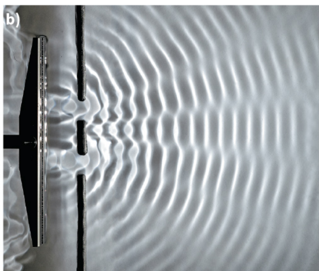
Ryc. 11.1. Dwie nakładające się fale kołowe, wytworzone przez dwa źródła (a) i wychodzące z dwóch szczelin (b)
