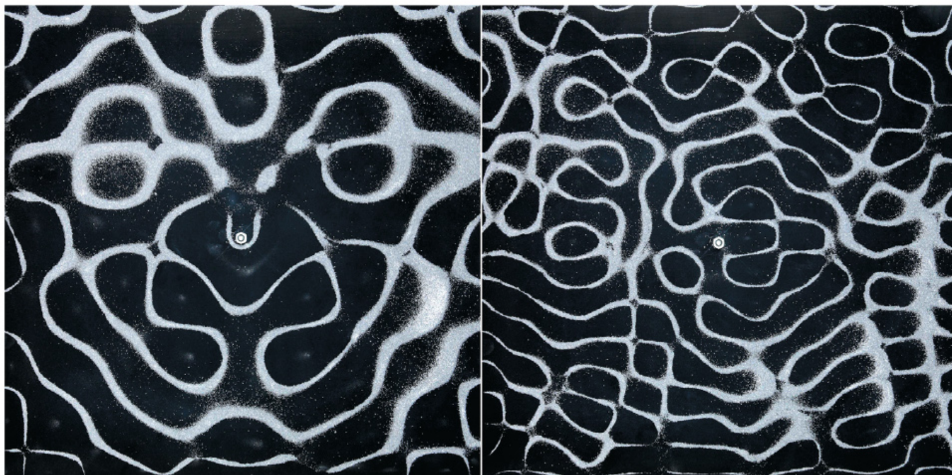
Ryc. 11.6. Fale stojące powstające na płaszczyźnie mogą mieć dosyć skomplikowany charakter. Na zdjęciach białe obszary to miejsca, w których nie obserwuje się drgań ośrodka.
