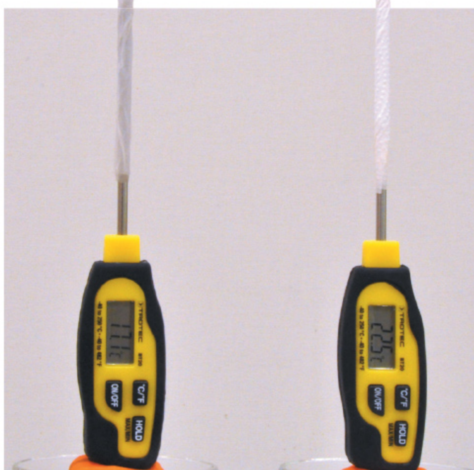
Ryc. 23.2. Termometr owinięty wilgotną bibułą wskazuje temperaturę niższą niż temperatura otoczenia, którą wskazuje drugi termometr
