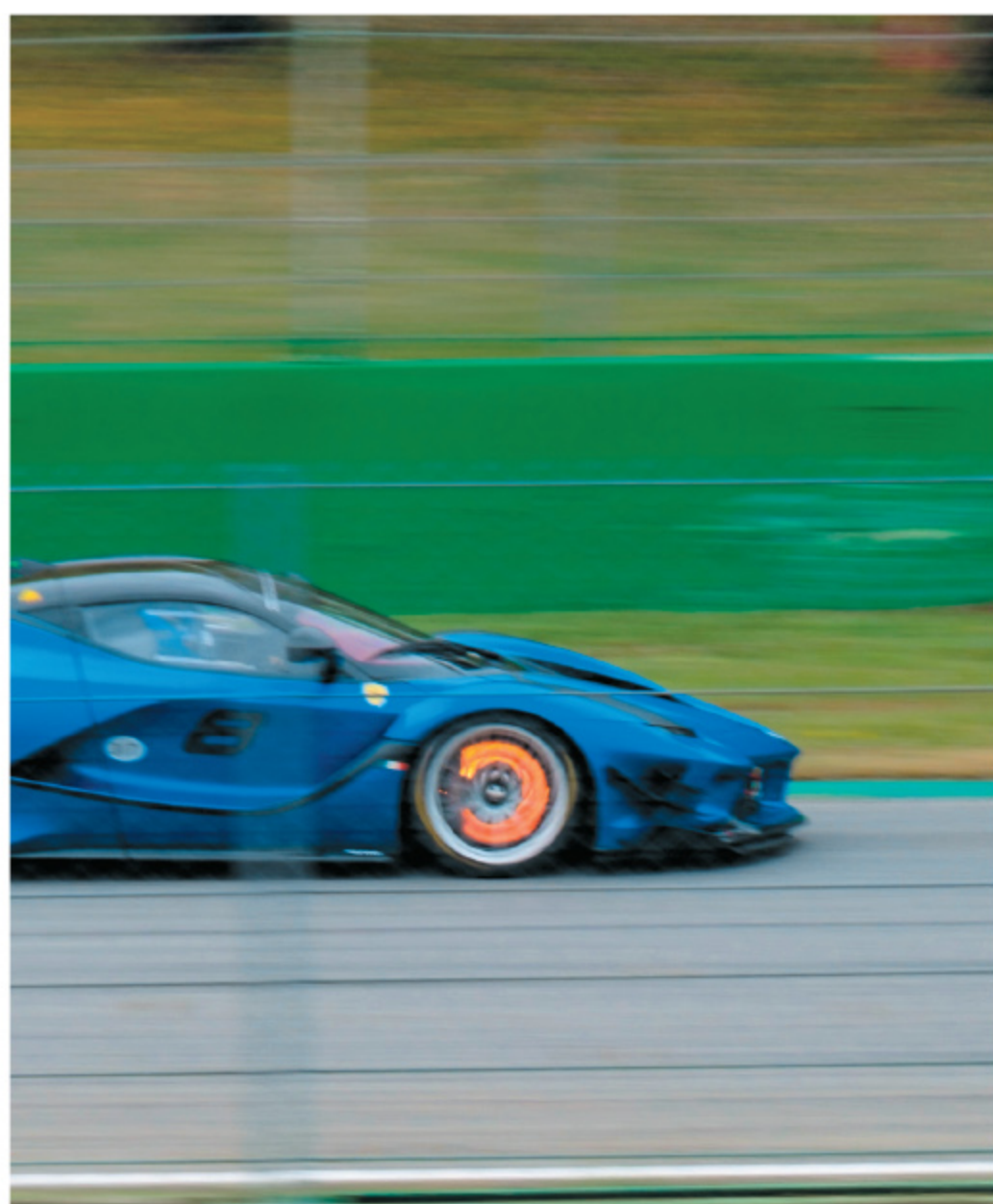
Ryc. 20.1. Tarcze hamulcowe świejące z powodu rozgrzania
