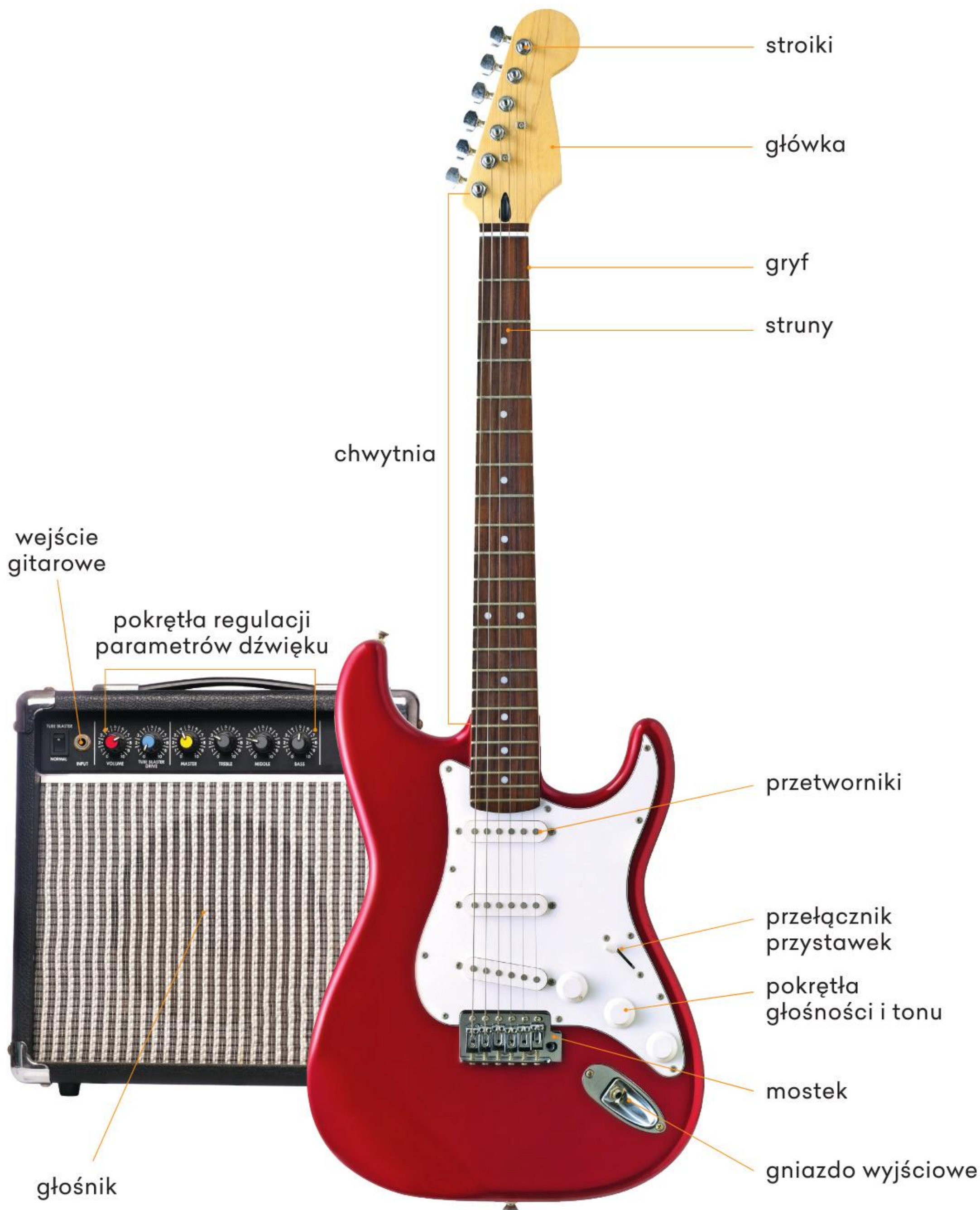
Schemat budowy gitary elektrycznej wraz ze wzmacniaczem dźwięku
