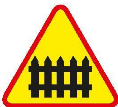
Przejazd kolejowy z zaparami
