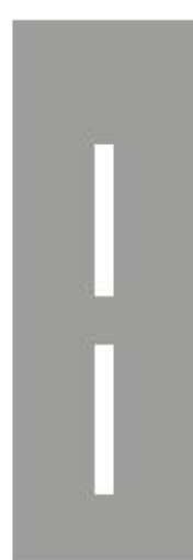
Linia krawędziowa przerywana
