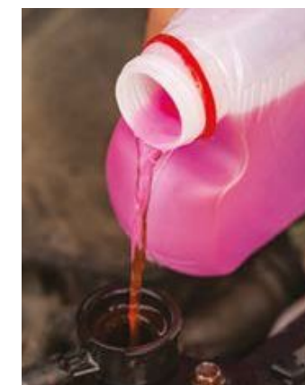
Fot. 10. Etano-1,2-diol (glikol etylenowy) ze względu na swoje właściwości fizyczne jest składnikiem płynu do chłodnic samochodowych.
