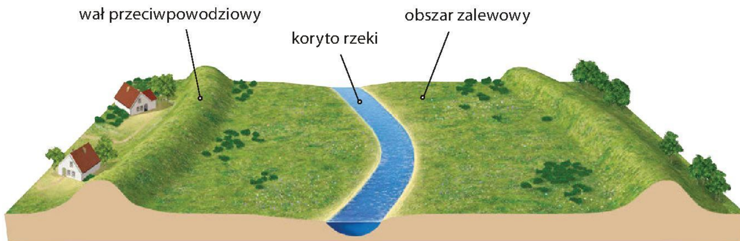
Schemat doliny rzecznej z wałami przeciwpowodziowymi.
