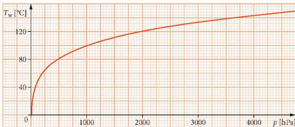
Rys. 7.54. Wykres zależności temperatury wrzenia wody od ciśnienia atmosferycznego
