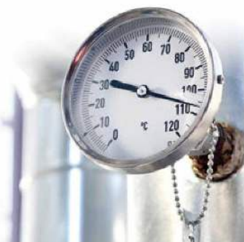
Rys. 8.6. W termometrze gazowym temperatura jest określana na podstawie ciśnienia gazu przy jego stałej objętości
