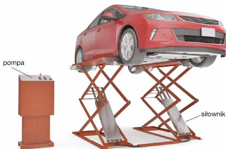
Rys. 7.9. Podnośnik hydrauliczny pozwala podnieść samochód w warsztacie
