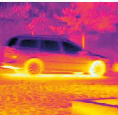
Rys. 8.29. Znaczna część energii paliwa jest zużywana na podgrzewanie samochodu i jego otoczenia
