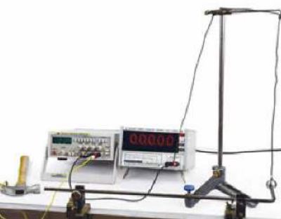
Rys. 10.9. Układ do pomiaru prędkości fali w metalu
