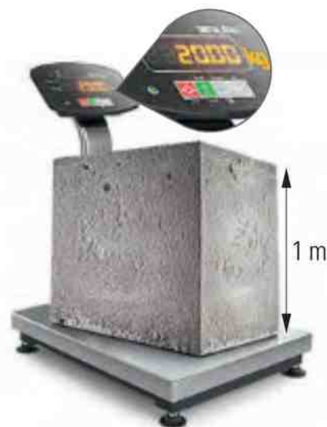
Sześcienny betonowy blok.
