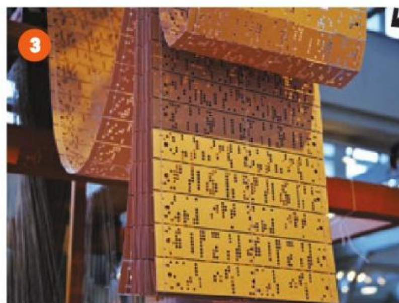
1 Urządzenie Cartwrighta 2 Krosno Jacquarda 3 Karta programująca
