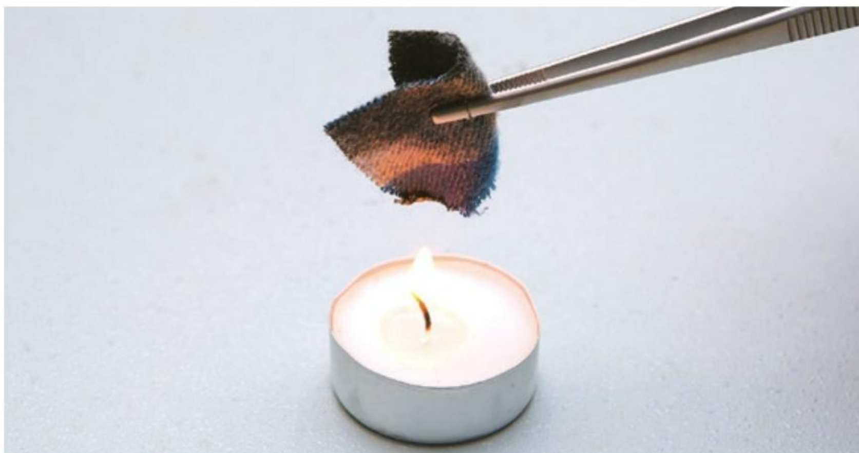
Właściwy sposób przeprowadzania próby ogniowej
