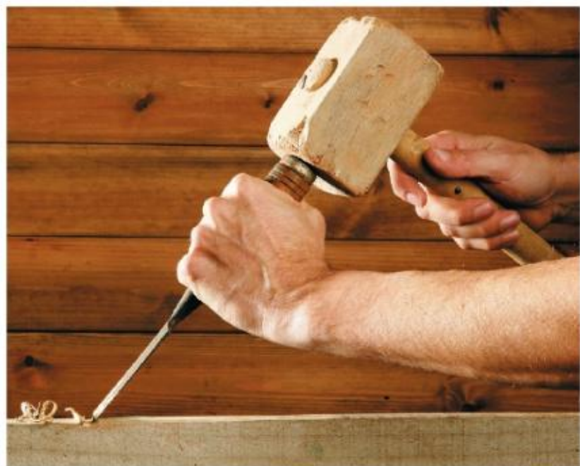
Prawidłowy sposób trzymania dłuta
