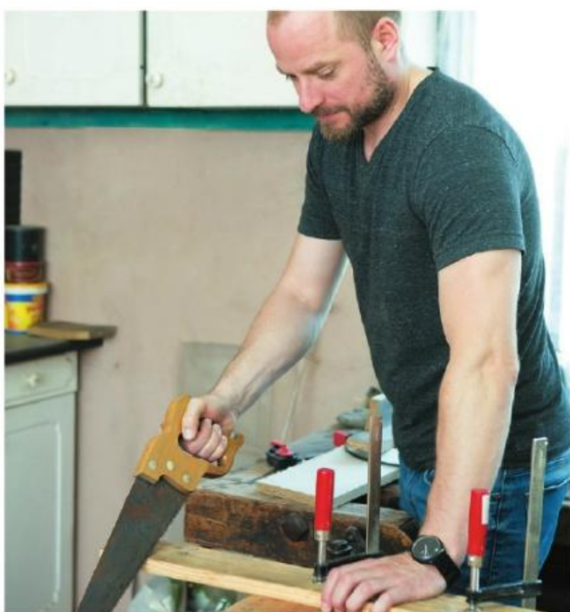
Prawidłowa postawa podczas cięcia piłą ręczną
