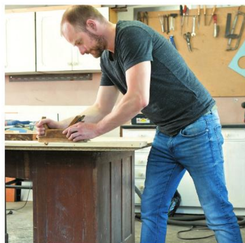
Prawidłowe trzymanie ręcznego struga i właściwa postawa podczas strugania drewna
