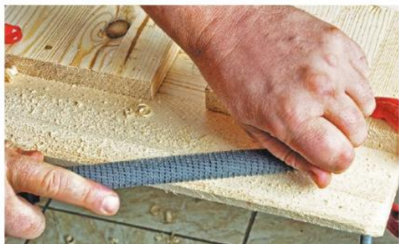
Prawidłowy sposób trzymania tarnika lub pilnika
