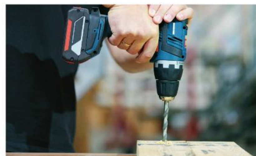
Prawidłowe trzymanie narzędzi podczas wiercenia otworów
